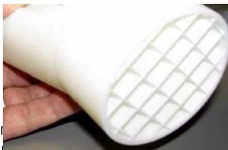
Изготовление сердечника на установке Fortus компании Stratasys осуществляется по предварительно сгенерированной программе. В зависимости от расположения в камере построения, заданной точности, шага внутренней решетки
