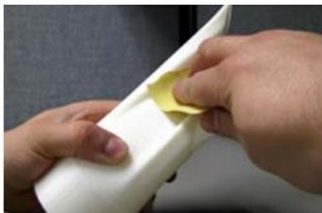
В принципе, изделия, получаемые на установках Fortus, можно сразу использовать по прямому назначению. Однако, в силу особенностей технологического процесса, от оператора может потребоваться удалить поддерживающие элементы конструкции модели и, при необходимости, выполнить шлифовку поверхности, например, наждачной бумагой (рис. 8). Если модель составная,
