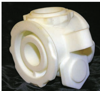
Рис. 1. Модель «Корпус насоса» из ABS-пластика
