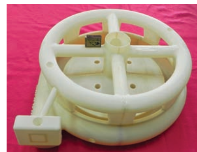
Рис. 6. Модель корпуса с элементами ЛПС, изготовленная из 12 частей
