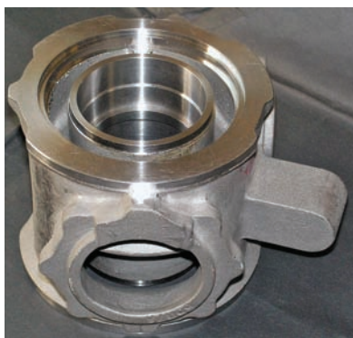
Рис. 3. Литая деталь «Корпус насоса»
