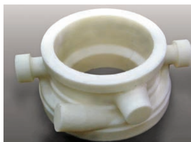
Рис. 8. Примеры моделей отливок новых изделий
