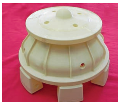
Рис. 7. Модель модельного блока, изготовленная из 24 частей
