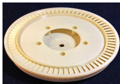
Рис. 9. Модель «Рабочее колесо» была изготовлена для «КБХА» в «Солвер» на установке Fortus 900ms
