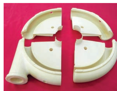
Рис. 4. Модель улиточного корпуса, изготовленная из 4 частей
