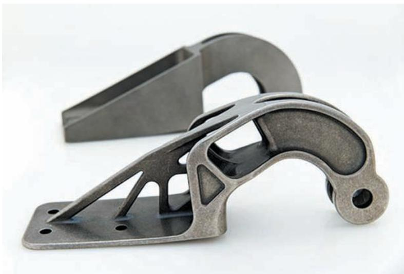
Рис. 2. Два варианта петли для кожухов двигателей Airbus A380. На переднем плане – бионический вариант, изготовленный методом металлической 3D-печати
