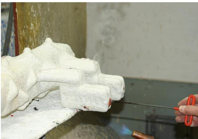
Растопить воск в вентиляционных отверстиях можно с помощью нагретой пики, как показано на рисунке. Таким образом вы будете гарантировать снижение давления внутри QuickCast модели во время автоклава и цельность оболочковой формы.
