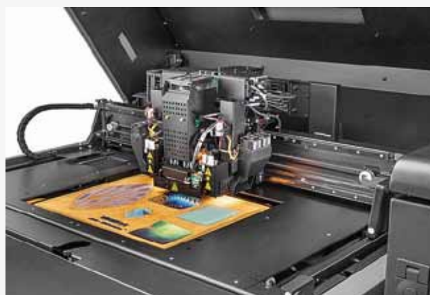
Рис. 3. Процесс работы принтера по технологии MJM/PolyJet на ткани, компания Stratasys Inc. [3]
