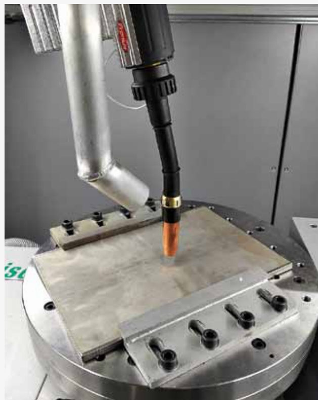
Рис. 6. Круглый поворотный стол на 3d-принтере Gefertec arc405, технология 3DMP/WAAM, компания Gefertec GmbH [4]
