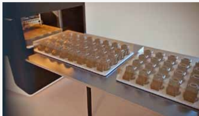
Рис. 7. Конвейерный тип стола с декартовой системой координат, технология STEP, компания Evolve Additive Solutions [6] Fig. 7. Conveyor-type table with cartesian reference system, STEP technology, Evolve Additive Solutions [6]
