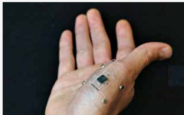
Рис. 14. Компонент носимой электроники, полностью напечатанный на 3d-принтере, способный принимать форму тела человека или животного (Hansjörg Wyss Institute for Biologically Inspired Engineering at Harvard University [17])
