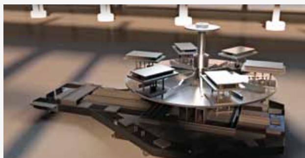
Рис. 9. Карусельный стол с декартовой системой координат технологии MoldJet (источник Tritone Technologies [10])
