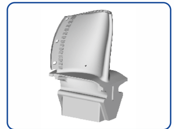
Лопатка турбины с каналами охлаждения Материал: кобальт-хромовый сплав КХ28М6 (МР1) Габаритные размеры: 75x38x75 мм Время выращивания: 7 часов
